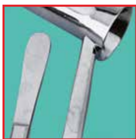
Пятна вследствие высокого содержания соли в воде для заключительной промывки
