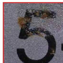
Язвенная коррозия пинцета. Причина: лента цветовой кодировки из-за старения пропускает вредные хлорсодержащие вещества.
