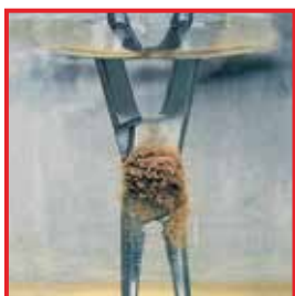
Образование ржавчины после многочасового погружения в физиологический солевой раствор
