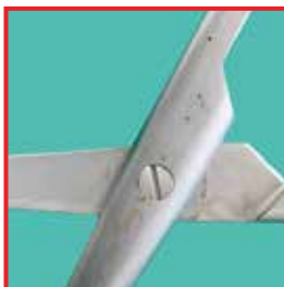
Ножницы с язвенной коррозией
