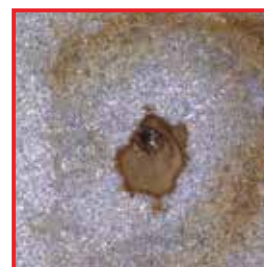
Пример язвенной коррозии
