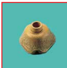
Трещины старения на респираторной маске
