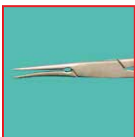
Деформация вследствие неправильного обращения
