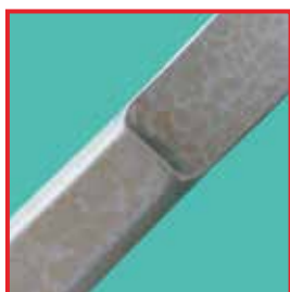
Пример пятен в результате загрязнений конденсата пара
