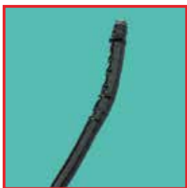
Набухание дистального конца фиброскопа
