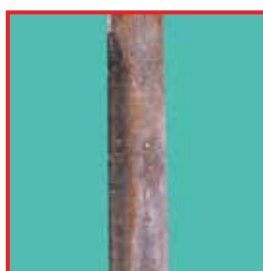
Штамп костевой, поверхность скольжения шибера со следами коррозии
