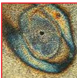
Пример язвенной коррозии
