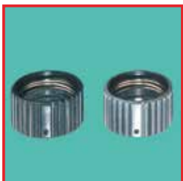
Изображение справа: повреждение материала умягченной водой.
