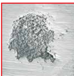
Коррозионное отверстие – под растровым электронным микроскопом – 200-кратное увеличение
