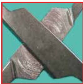
Коррозия металла вследствие недостаточного использования средств для ухода
