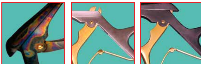
Пример: черный перфоратор с покрытием TiAlN. Из-за частично удаленного слоя с пестрой переливчатой окраской или полностью удаленного слоя с целостными позолоченными компонентами. Правый перфоратор: новый
