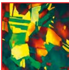
Цветное травление - аустенитная микроструктура, нержавеющая и кислотостойкая инструментальная сталь (500-кратное увеличение)
