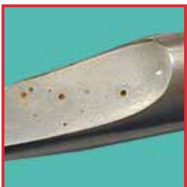
Язвенная коррозия инструмента под действием хлоридов.
