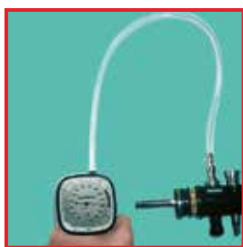
Ручная проверка герметичности гибкого эндоскопа
