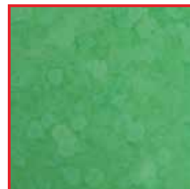
Воздействие на материал натуральной/анодированной поверхности алюминия контейнеров. Причина: моющий раствор с недопустимо высоким содержанием щелочи
