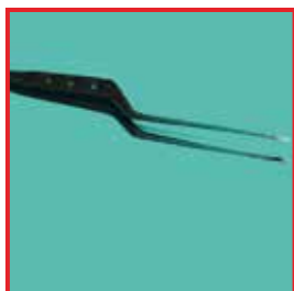
Деформация вследствие неправильного обращения
