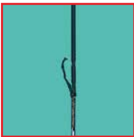
Нарушенная изоляция ВЧ-инструмента
