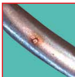
Язвенная коррозия пинцета. Причина: лента цветовой кодировки из-за старения пропускает вредные хлорсодержащие вещества.
