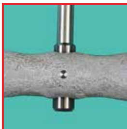
Коррозия материала алюминиевой рукоятки. Причина: непригодное щелочное средство очистки
