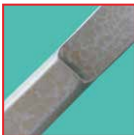
Пример пятен, вызванных кремниевой кислотой в конденсате пара
